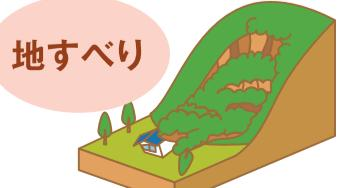
斜面の一部あるいは全部が、地下水の影響と重力によってゆっくりと斜面下方に移動する。
