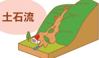
山腹、川底の石や土砂が長雨や集中豪雨などによって、一気に下流へと押し流される。
